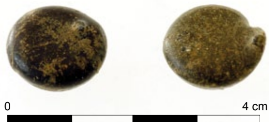
Ryc. 3. Kule „niedolane” (nr inw. pol. 5/5). Fot. M. Gorzkowska. Fig. 3. Bullets with lesser perimeter due to incomplete filling the mould. Photo M. Gorzkowska.
